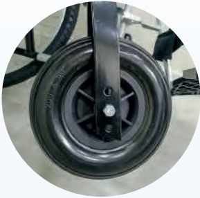
Horquilla de aluminio Posee 3 regulaciones de altura
