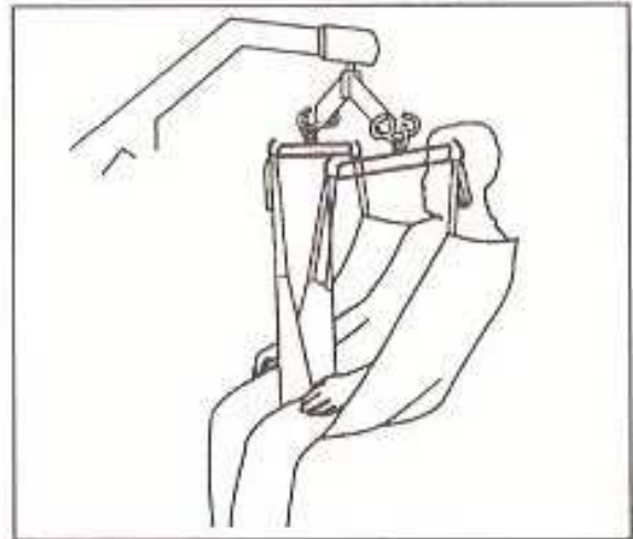
Fig. 4 Eleve la grúa ligeramente. Coloque las bandas más cortas de los hombros, en los enganches traseros de la percha. Mientras realiza esta operación, mueva la grúa hacia el usuario.
